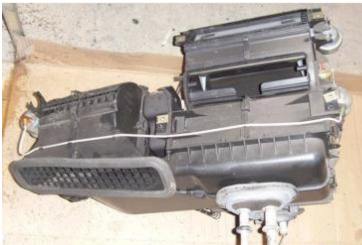
Bild links: Heizungskasten ausgebaut, komplett: rechts die beiden Druckdosen für die Luftauslassklappen, unten Mitte die Anschlüsse für Heiz- und Klimakreislauf, oben Luftauslass zur Frontscheibe, links die Druckdose der Umluftklappe. Bild rechts: Nachaufnahme einer Druckdose.
