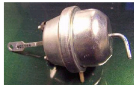
Bild links: Heizungskasten ausgebaut, komplett: rechts die beiden Druckdosen für die Luftauslassklappen, unten Mitte die Anschlüsse für Heiz- und Klimakreislauf, oben Luftauslass zur Frontscheibe, links die Druckdose der Umluftklappe. Bild rechts: Nachaufnahme einer Druckdose.
