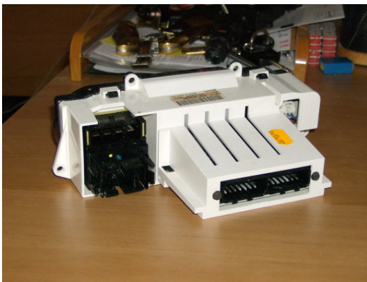
SATC-Regelmodul, ausgebaut, Rückansicht
