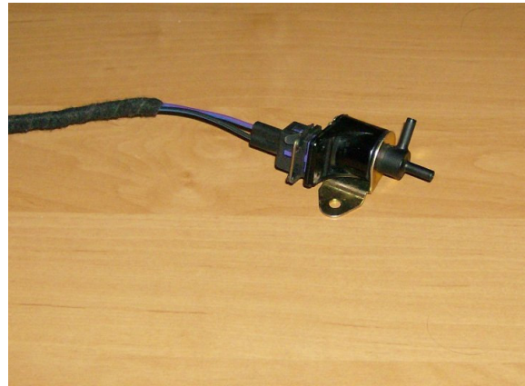
Magnetventil für Unterdrucksteuerung Umluftklappe
